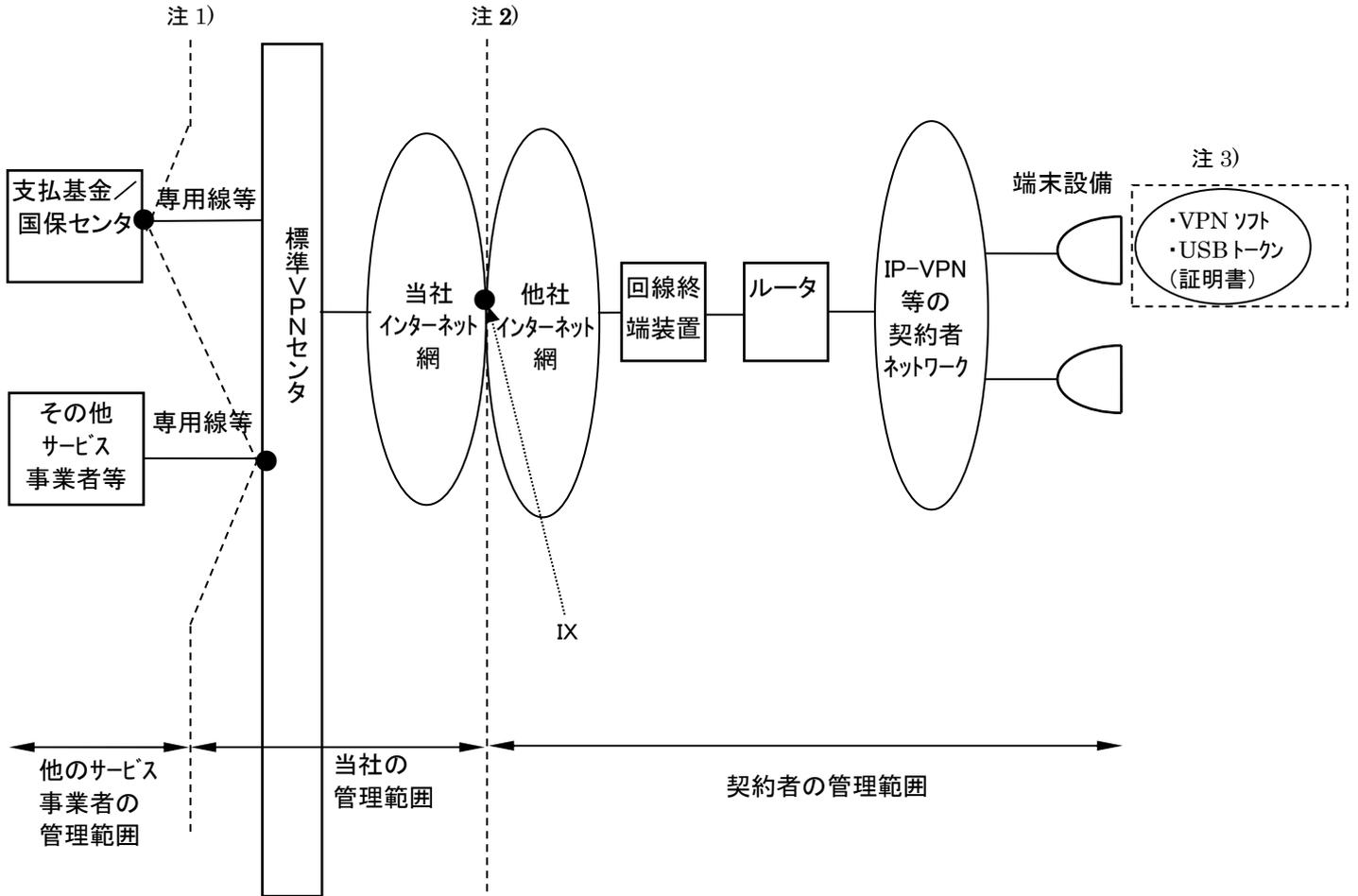
注1) 上図にて責任分解点を破線で示します。インターネット網の当社管理範囲は、加入IX迄の設備とします。
