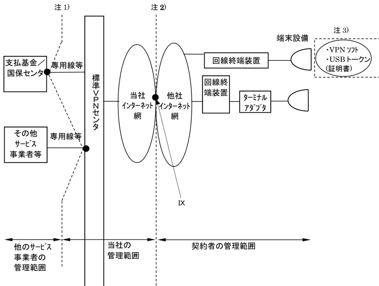
注1) 上図にて責任分解点を破線で示します。インターネット網の当社管理範囲は、加入IX迄の設備とします。
